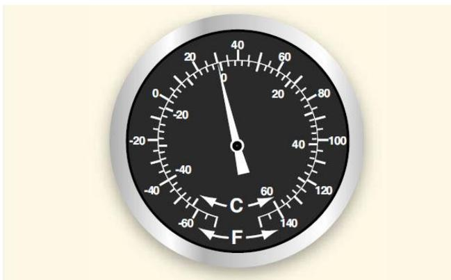
**Figura 7-38.** *Indicador de temperatura exterior del aire (OAT).*
