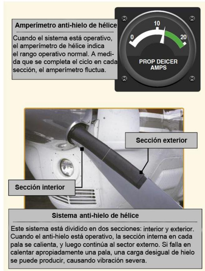
**Figura 6-50.** Botas anti-hielo y amperímetro de hélice.
