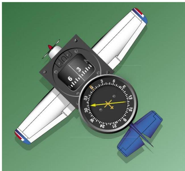
**Figura 15-36.** ADF con esfera fija y compás magnético.
