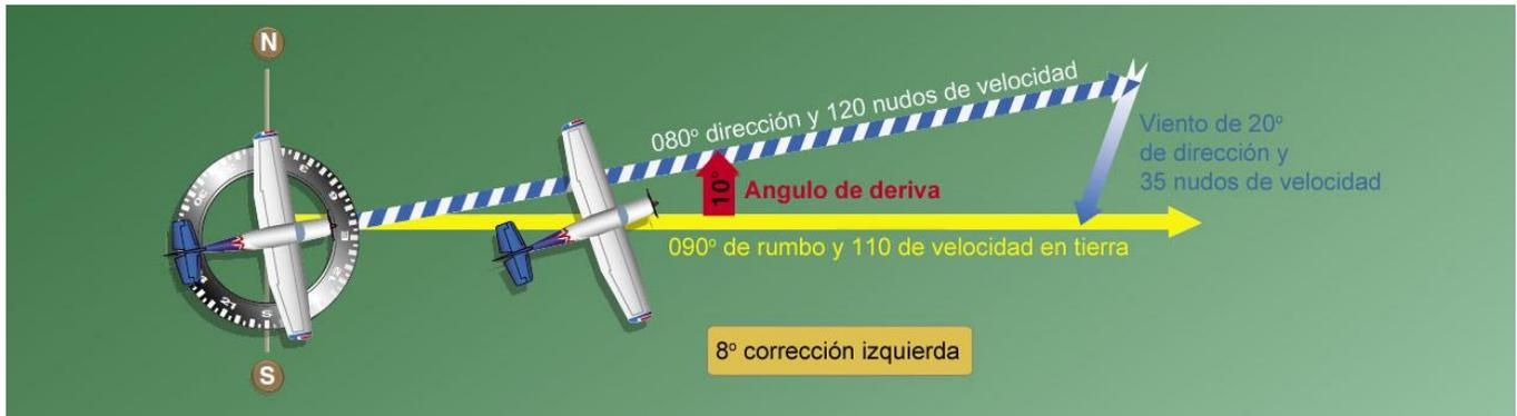
**Figura 15-19.** Principio del triángulo de velocidades.
