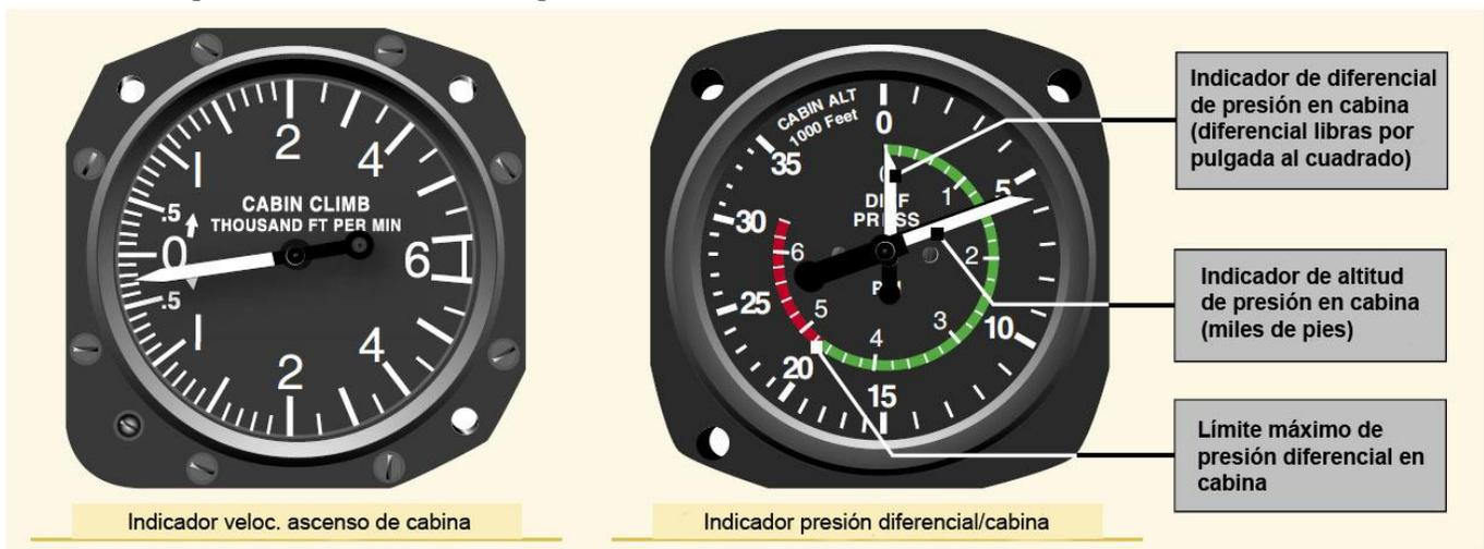
**Figura 6-42.** Instrumentos de presurización de cabina.
