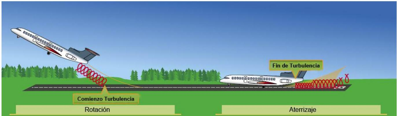
**Figura 4-12.** Evite la turbulencia de otra aeronave
