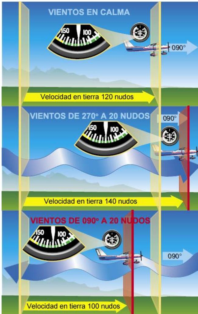
**Figura 15-13.** El movimiento del aire afecta la velocidad con que se mueve la aeronave sobre la superficie de la Tierra. La velocidad del aire, velocidad a la que se mueve una aeronave por el aire, no está afectada por el movimiento del aire.
