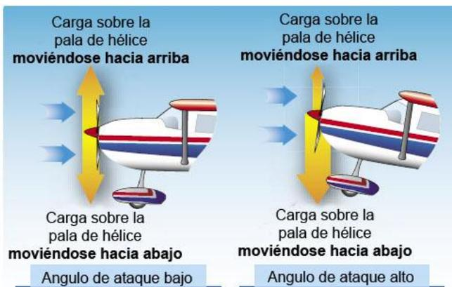
**Figura 4-43.** Carga asimétrica de la hélice (*Factor P*)
