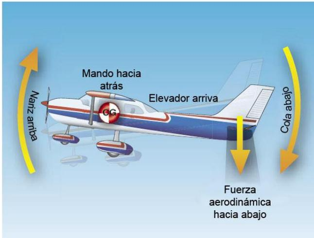
**Figura 5-10.** El elevador es el control primario para cambiar el cabeceo de una aeronave.
