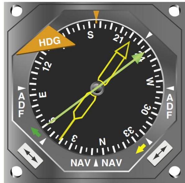
**Figura 15-31.** *Indicador radio magnético.*
