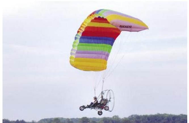
**Figura 4-17.** *Paracaídas impulsado por motor*
