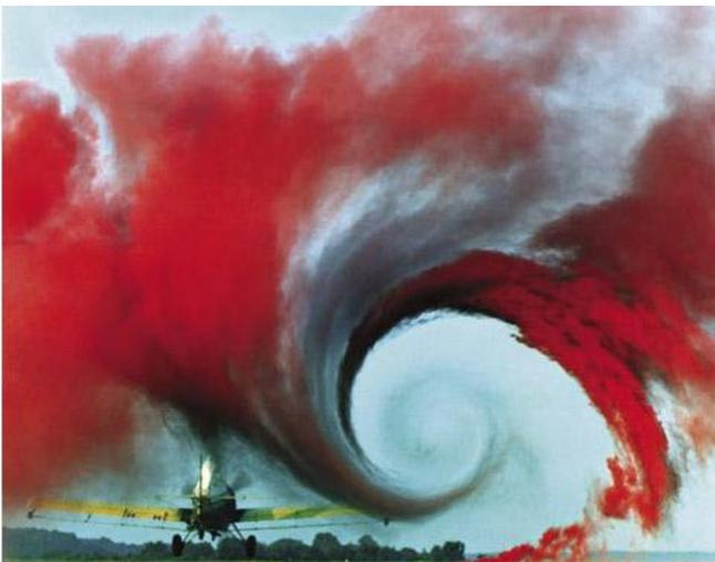
**Figura 4-7.** Vórtices de punta alar en un fumigador
