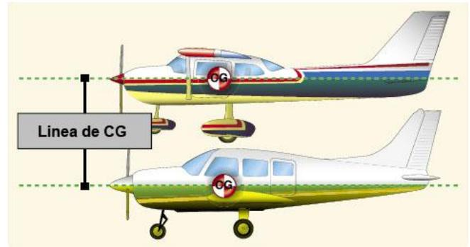
**Figura 4-26.** Área del fuselaje para estabilidad lateral
